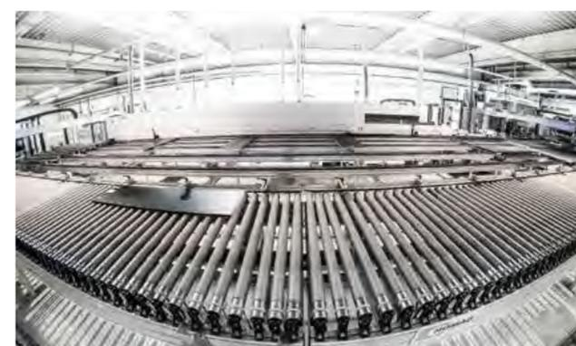
Nach dem Zuschnitt erhalten die Elemente einen unverwechselbaren Barcode und machen sich auf den Weg zum nächsten Bearbeitungsschritt. After they have been cut to shape, the items are given a unique barcode and sent on their way to the next processing phase.
