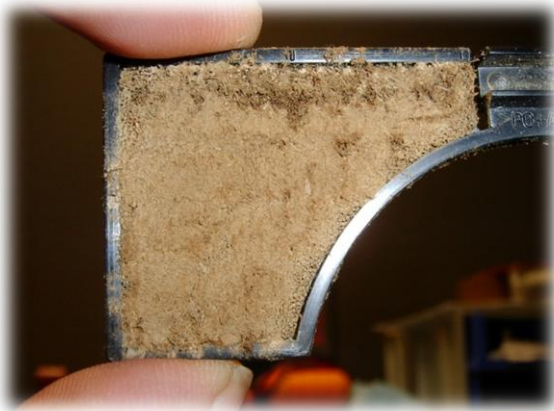
Filter wurde nie gereinigt
