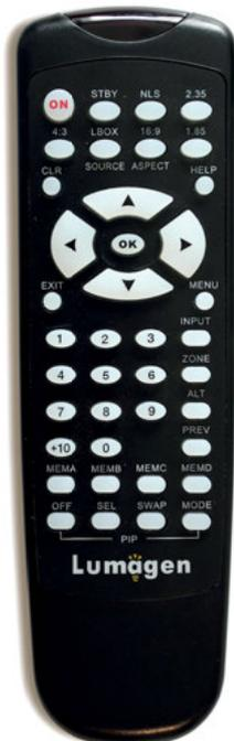
Die handliche Fernbedienung besitzt eine hinterleuchtete Tastatur. Mehrere Direktwahltasten erleichtern die Bedienung in der Praxis.
