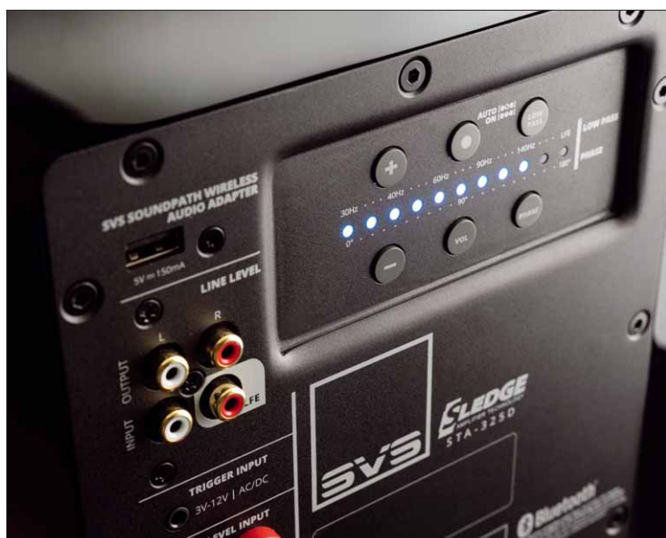
Neben Bedienfeld und analogen Ein- und Ausgängen gibt es den Erweiterungsport zur drahtlosen Signalübermittlung
