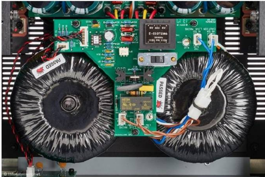
Zwei dieser kräftigen Trafos werden in den jeweils identischen symmetrischen Verstärkerzüge eingesetzt
