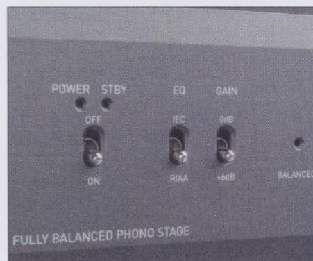
Zwei Entzerrerkennlinien, 6 dB Zusatzverstärkung: Die Ausstattung des Gerätes kann sich sehen lassen
